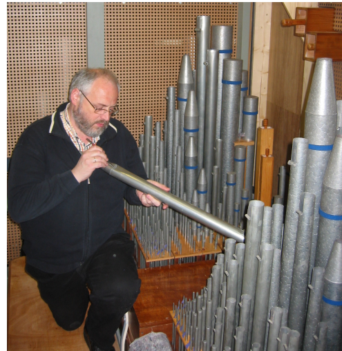
Orgelbaumeister Hubert Fasen bei der Intonation
