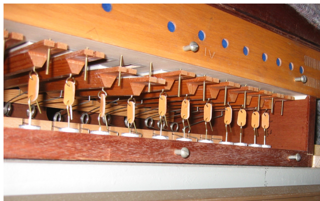
Blick in eine Windlade
