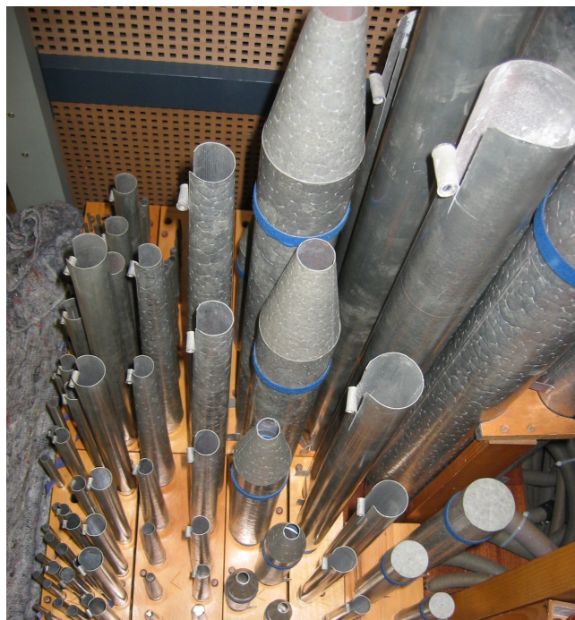
Register des Hauptwerkes in ihren verschiedenen Bauformen
