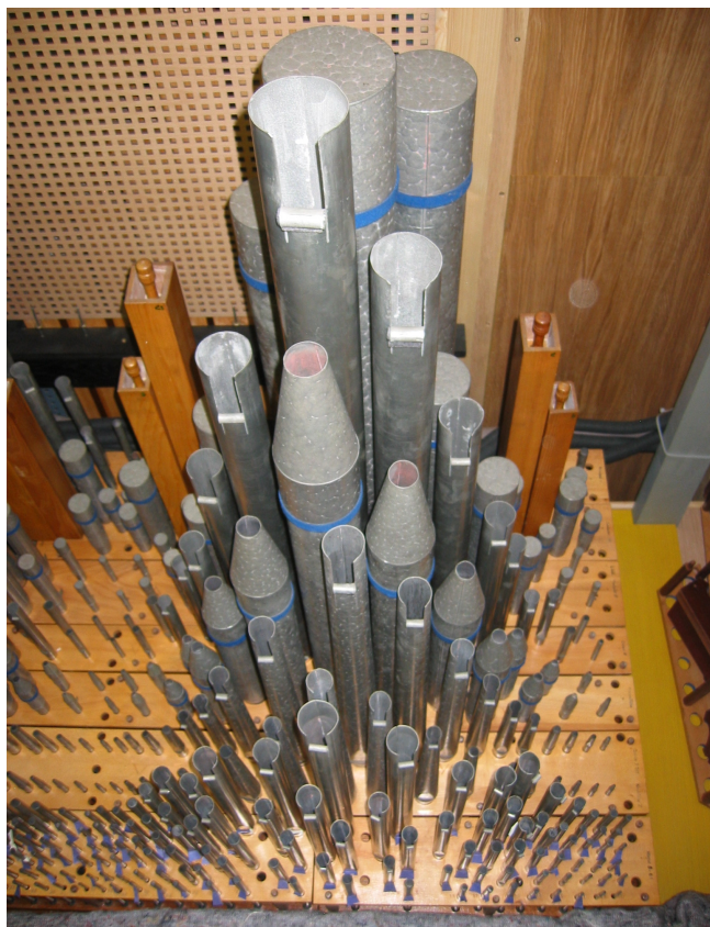
Verschiedene Pfeifenformen im Hauptwerk
